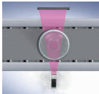
LED tápellátásának automatikus szabályozása (AC 3 ) az elszennyeződés és hőmérséklet-ingadozás kompenzálására (PET-re optimalizált típusok)
