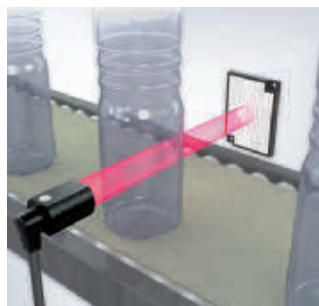
A PET-palackok megbízható érzékelése az egyedi P-opaqing technológiával
