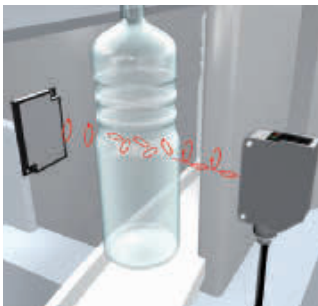
A kettős visszaverődés kihasználása PET anyagoknál az észlelés stabilitásának növeléséhez (PET-re optimalizált típusoknál)
