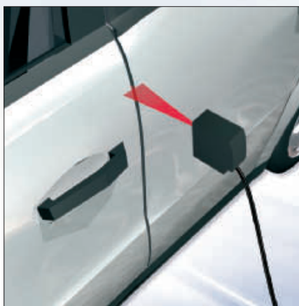
Pontos hézagmérés a gépjárműiparban
